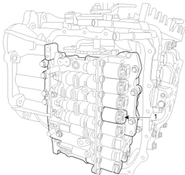
1. 低速档制动器控制电磁阀 (UD/B\_VFS)
